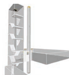
Colt Shaft | SYSTEM MECHANICZNEJ WENTYLACJI ODDYMIAJĄCEJ Przeznaczony przede wszystkim do budynków biurowych - ułatwiający dostęp jednostkom ratowniczo- gaśniczym w rejon kondygnacji objętej pożarem.
