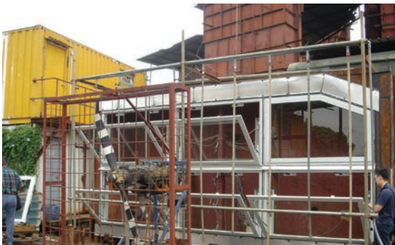
Stanowisko do prób deszczowych okien wentylacyjnych przeznaczonych do montażu w budynku Sky Plaza, Hong Kong
